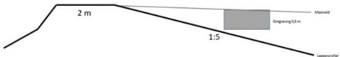
Figuur 3-1: Voorbeeld ontgraving binnen het waterstaatswerk met een leggerprofiel met kruinbreedte 2 m en binnentalud 1:5 (bron: Hoogheemraadschap van Delfland).
