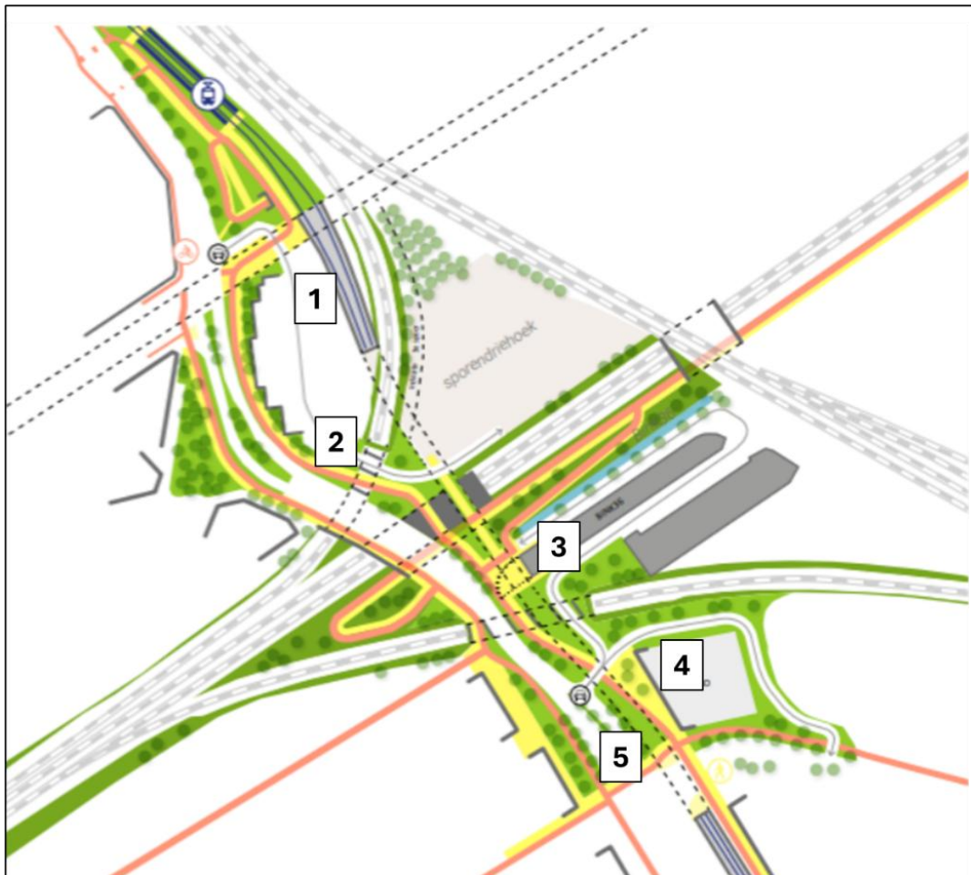
Figuur 26-3 Het tracé en de inrichting van de openbare ruimte voor de tunnelvariant. Bron: Ontwerpnota Vlietlijn Tunnelvariant Schetsontwerp, concept/0.1, gedateerd 18 april 2025
