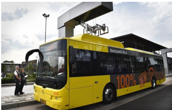
Figuur 5: Elektrische bus en pantograaf laadpunt lijn 1
