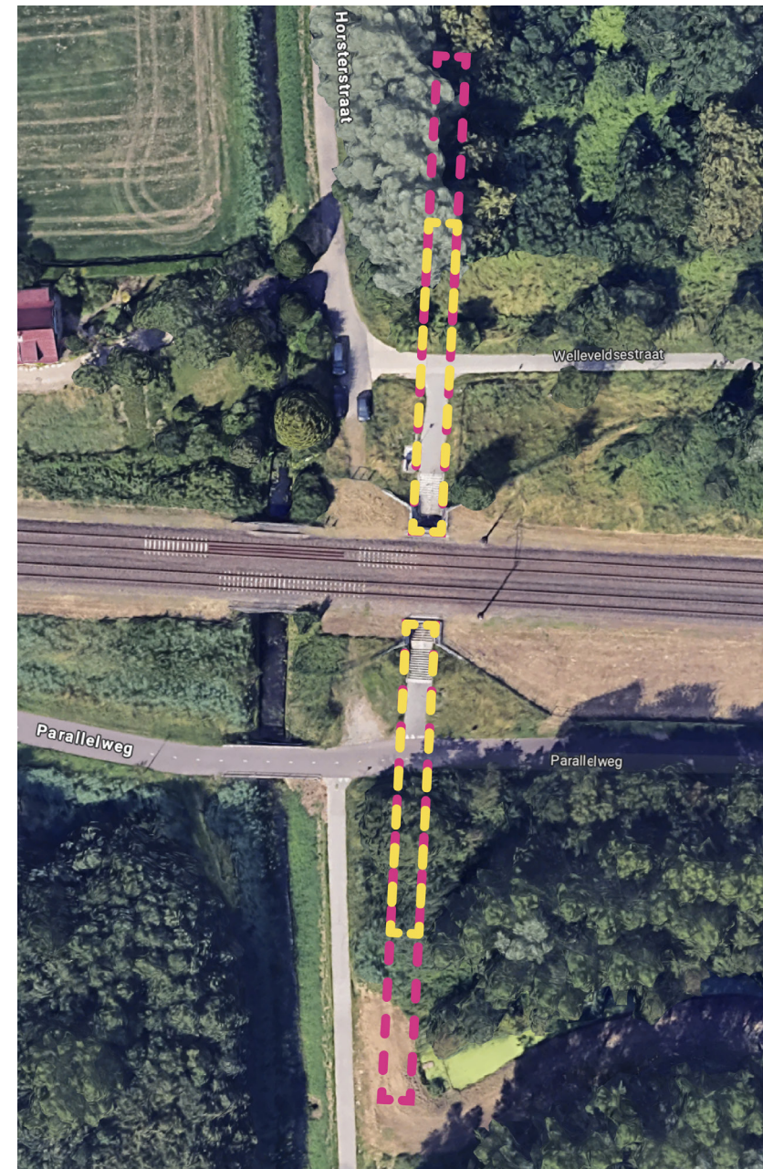
Voorbeelduitwerking met indicatie lengte mogelijke fietstunnel met een helling van 1:10 (geel) of 1:20 (roze).
