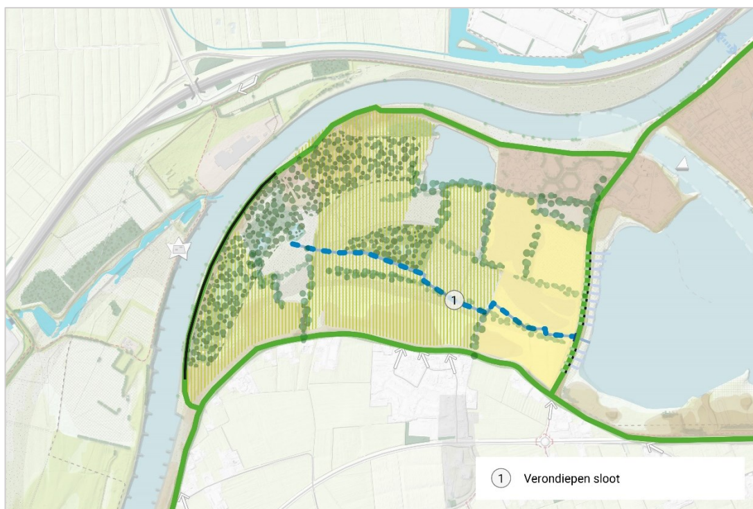
Figuur 4.12 Aanpassing afwatering, kade Marsweg met duikers
