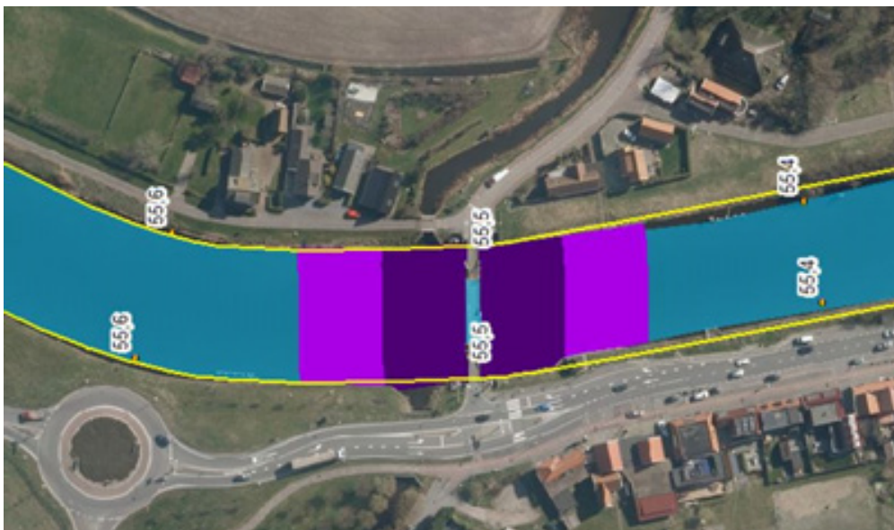
Figuur 6 | Veiligheidszone bij kunstwerken (25 & 50 m). Theoretische Vaarstrook gele lijn, veiligheidszone paars vlak, PVS blauw vlak
