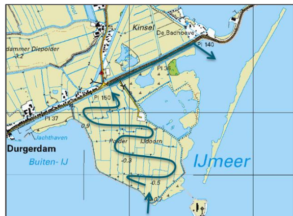
Figuur 2.3: Principe (visvriendelijk) in- en uitlaatsysteem water IJdoorn
