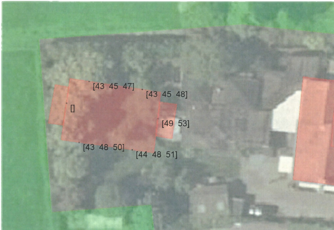
Figuur 4: geluidbelasting in dB, incl. aftrek, geluidbelasting per waarneemhoogte (respectievelijk 1,5/4,5/7,5 meter, zijgevels 4,5 en 7,5)
