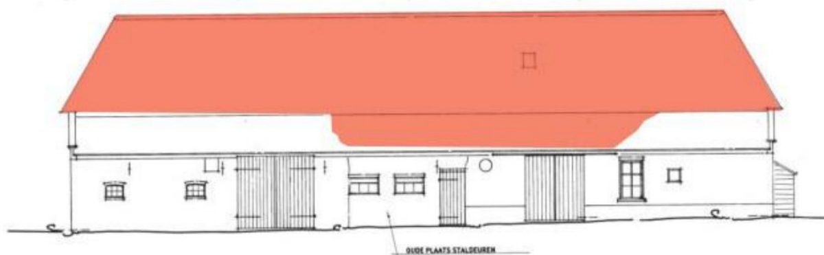
Figuur 8 - De rechter zijgevel zoals die oorspronkelijk was. In rood het gedeelte dat inmiddels is ingestort. Het betreft een groot deel van het dak (opmetingstekening Van Hooft Architecten, 2008).
