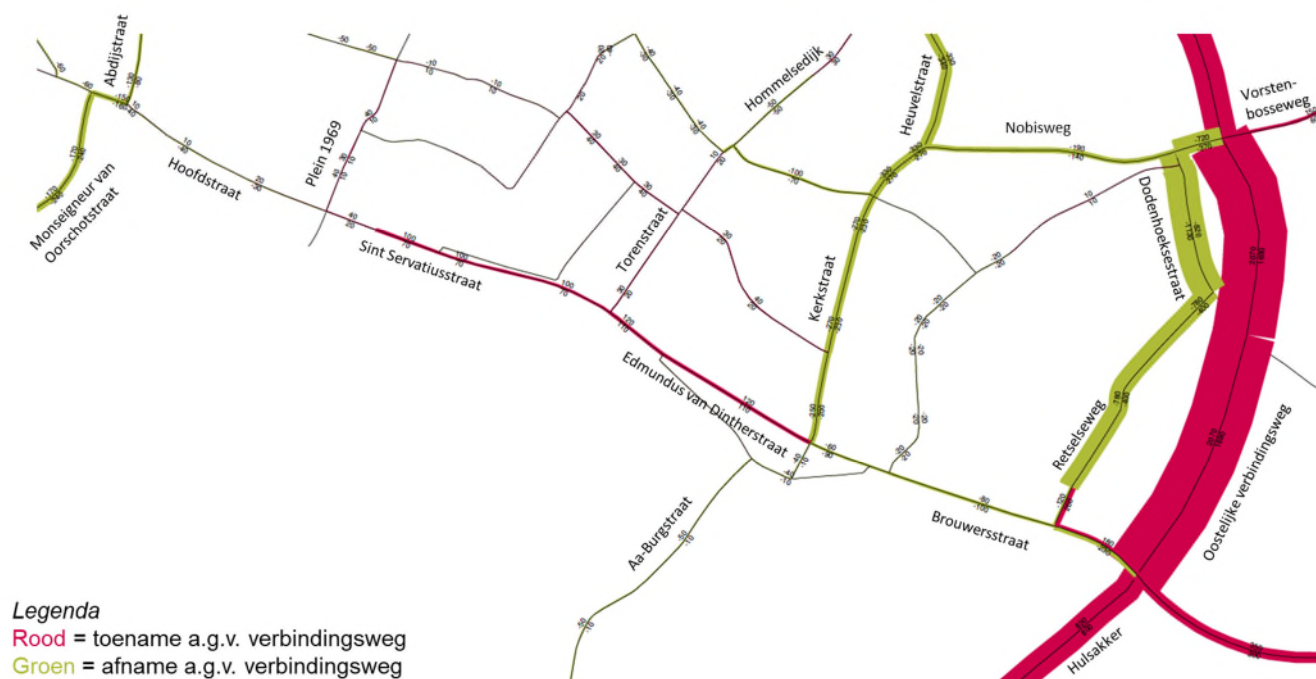
Figuur 7: Verschilplot etmaalintensiteit oostelijke verbindingsweg vs. referentiemodel 2030
