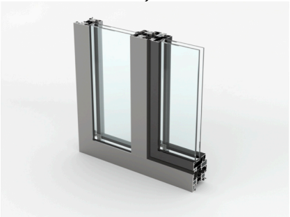
Aluminium kozijnen, type RT72, / kunststof kozijnen RAL 7024, mat, korrelstructuur, aanzichtbreedte max. 70mm, triple (binnen) beglazing
