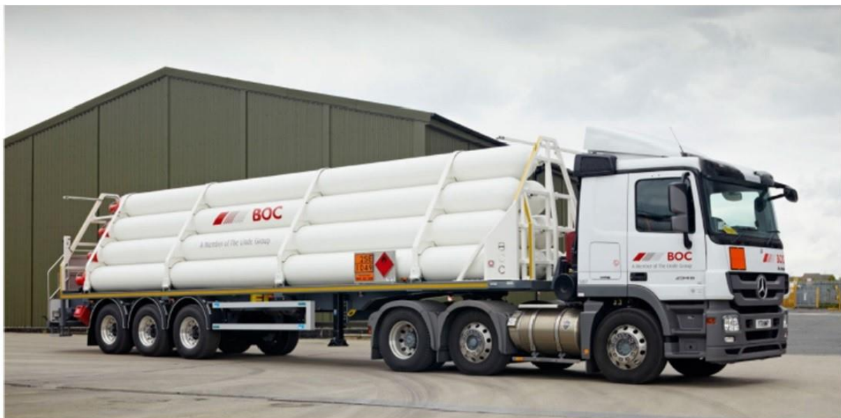
Een tube-trailer met 9 stalen drukcilinders ( 200 bar ) (M-Tech, 2020)
