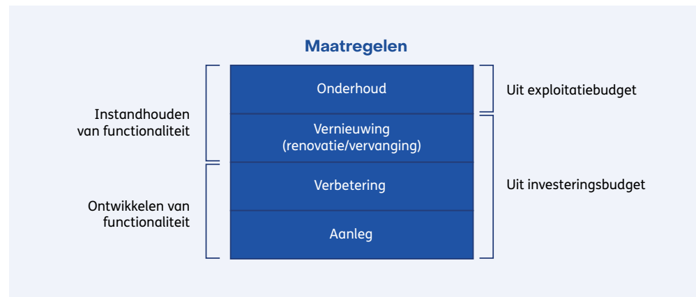
Figuur D.1 Begrippen met betrekking tot instandhouding en ontwikkeling van infrastructuur en de wijze waarop deze boekhoudkundig geassocieerd worden. De begrippen instandhouding en ontwikkeling volgen hierbij de begrippen zoals vanaf 2022 gehanteerd door het Rijk in aansluiting op Europese begrippen zoals beschreven in spoorrichtlijn 2012/34/EU.
