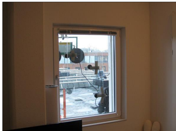
Foto II.2 Aanzicht microfoonposities in spouw
