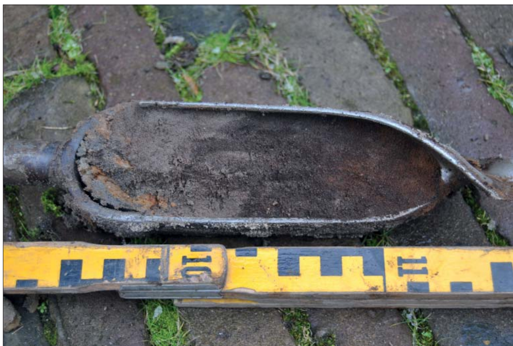
Afbeelding 9: In boring 3 werd nog een deel van de E-horizont aangetroffen, op de foto herkenbaar aan de lichtgrijze laag.
