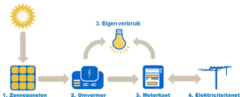
Figuur 1: Schematisch overzicht zonnestroomsysteem.
