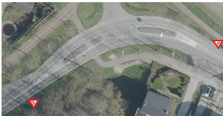
Figuur 16: Plaatsing borden J24 op Oosterweg / Zuiderdreef
