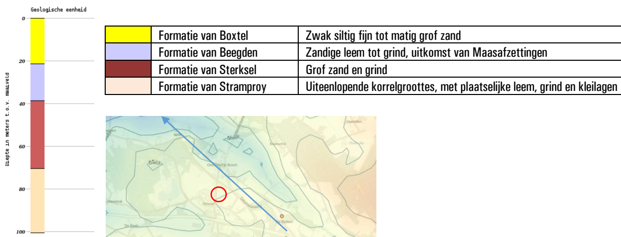
Figuur A: opbouw ondergrond.
