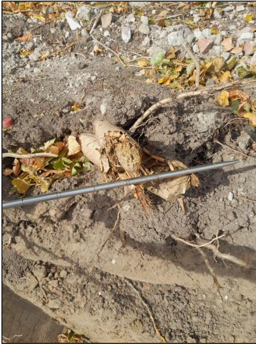
Afbeelding 7 en 8 : Detailopname beschadigde wortels boom 33
