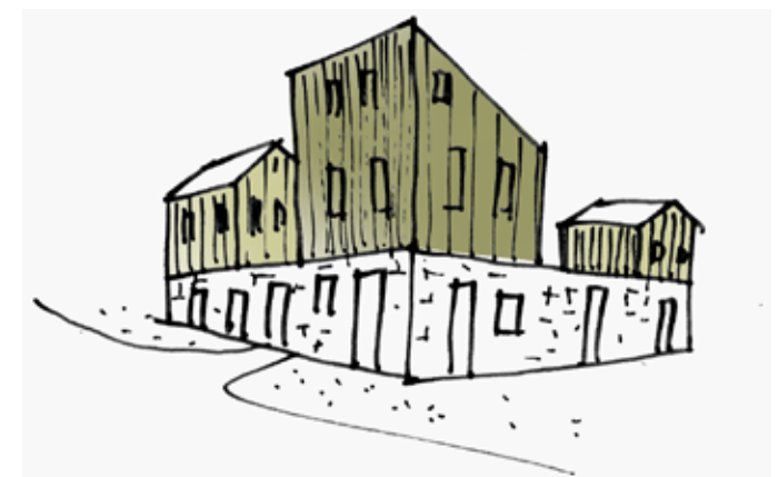
Binnenblok metselwerk plint met houten woningen erboven
