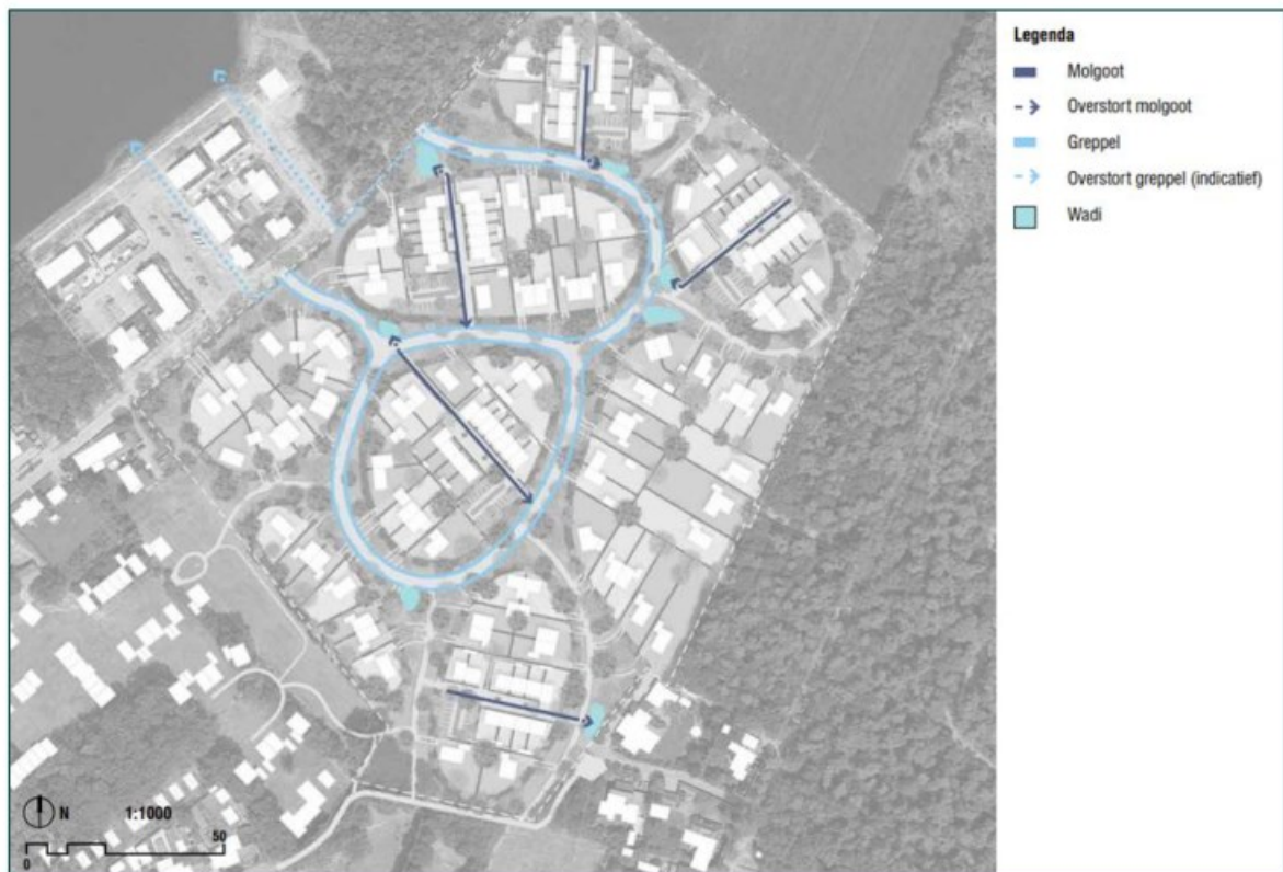
Figuur 4.5 Ontwerp van het watersysteem in de beoogde situatie (bron: Buro Lubbers).
