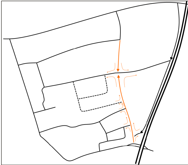
Afbeelding 10: Gestelsestraat uitgebreid met éénrichtingssysteem op het noordelijke deel
