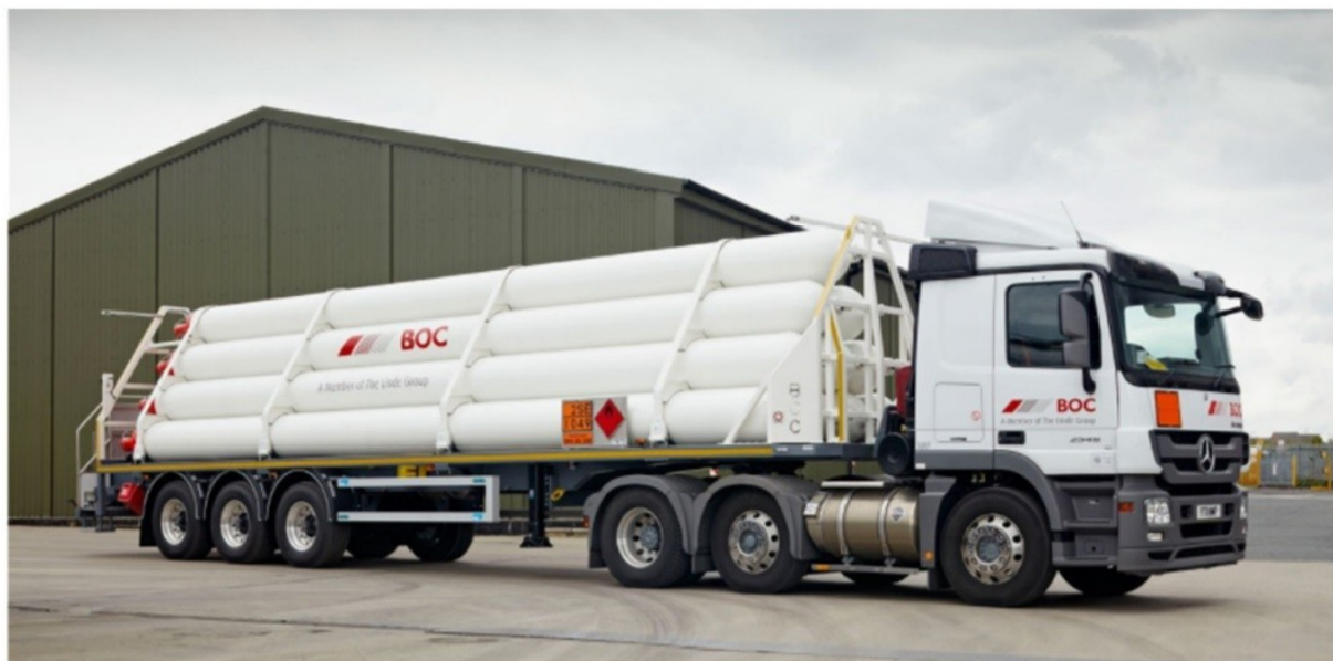
Een tube-trailer met 9 stalen drukcilinders (200 bar) (M-Tech, 2020)
