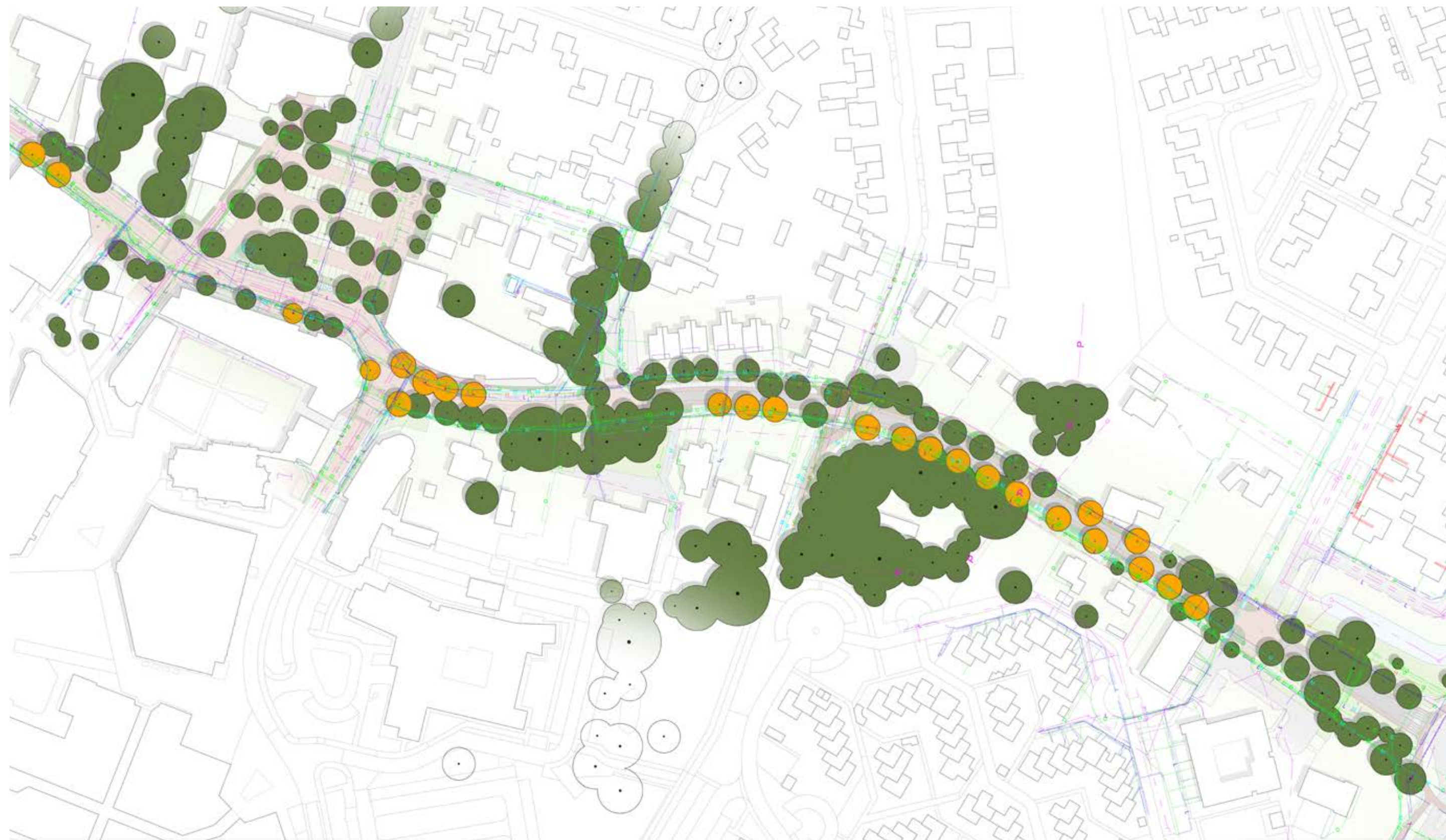
TE VERLEGGEN DATA EN/OF ELEKTRAKABELS T.B.V. NIEUWE BOMEN
