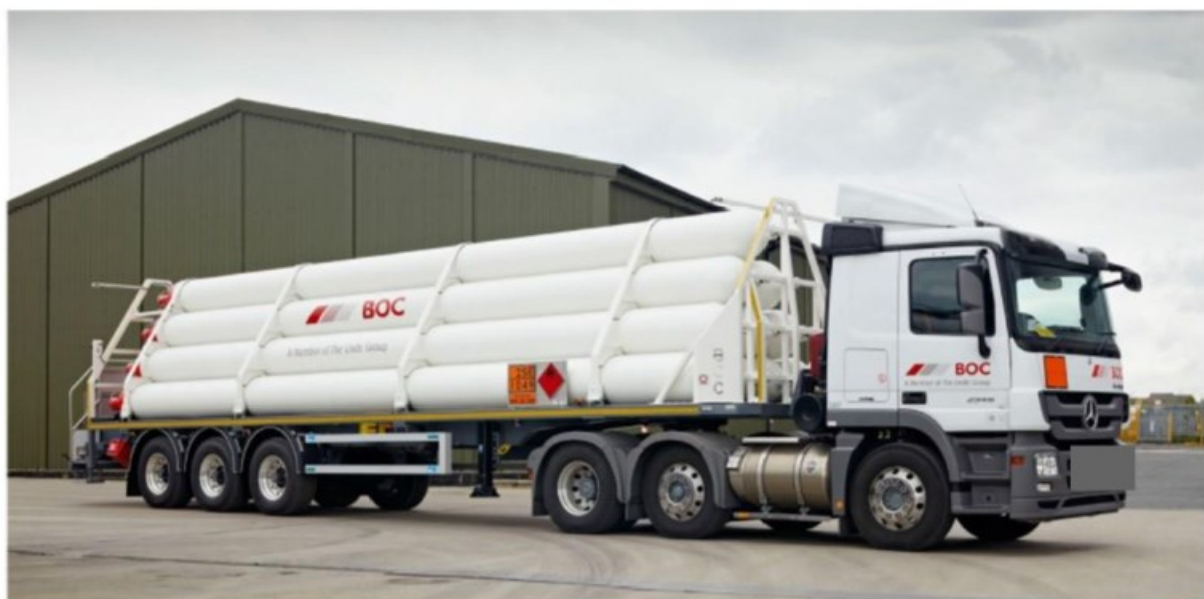
Een tube-trailer met 9 stalen drukcilinders ( 200 bar ) (M-Tech, 2020)
