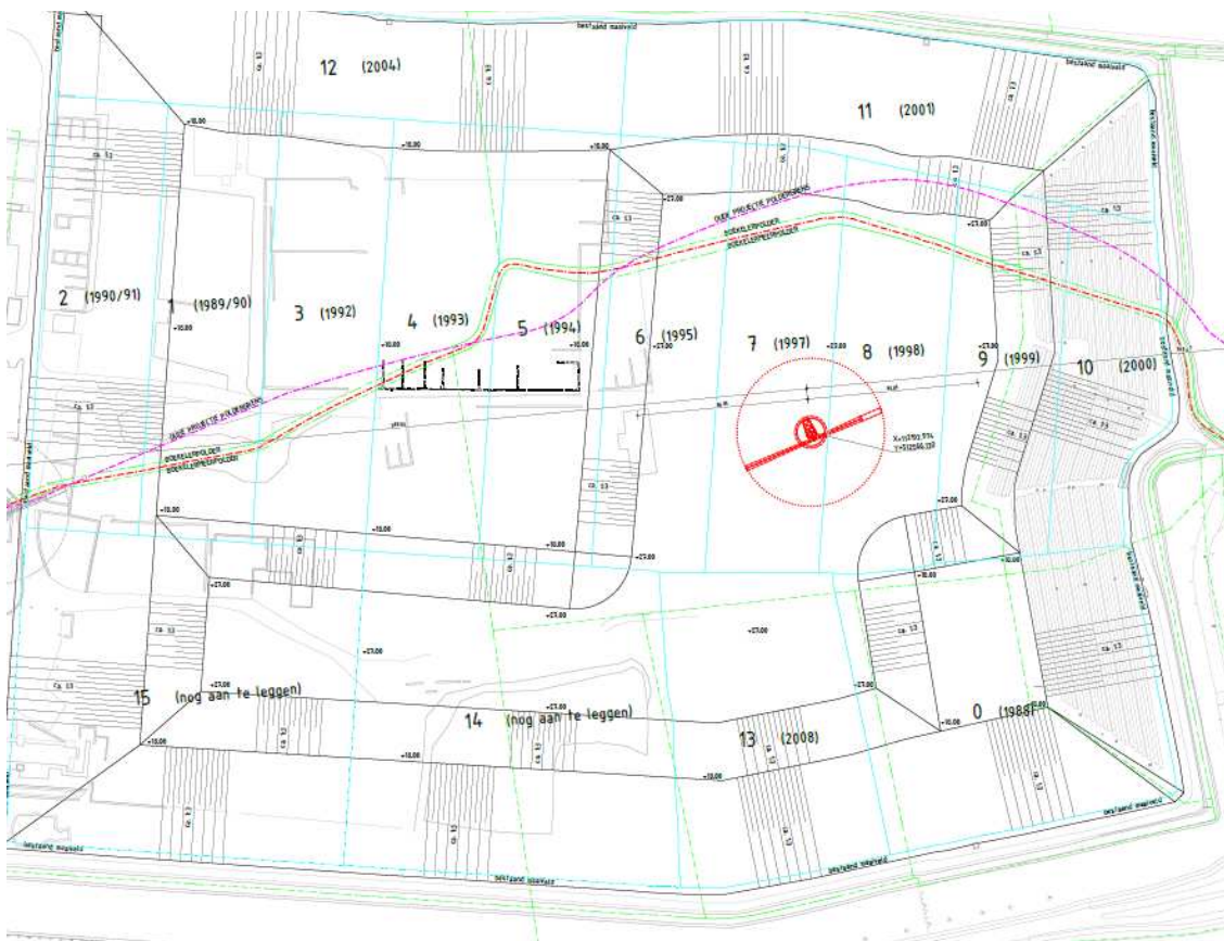
Figuur 2-1: bovenaanzicht deponie met beoogde positie van de derde windturbine [REF5]
