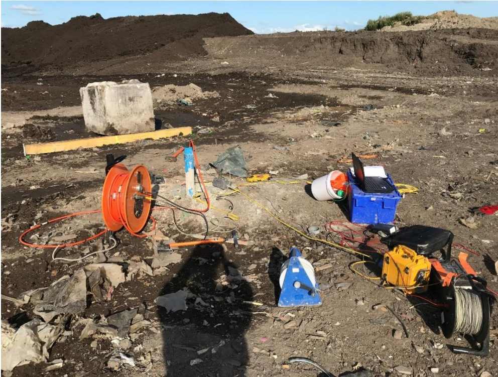
Foto 2.2: Foto van de uitvoering down hole seismisch onderzoek Sortiva, Alkmaar.
