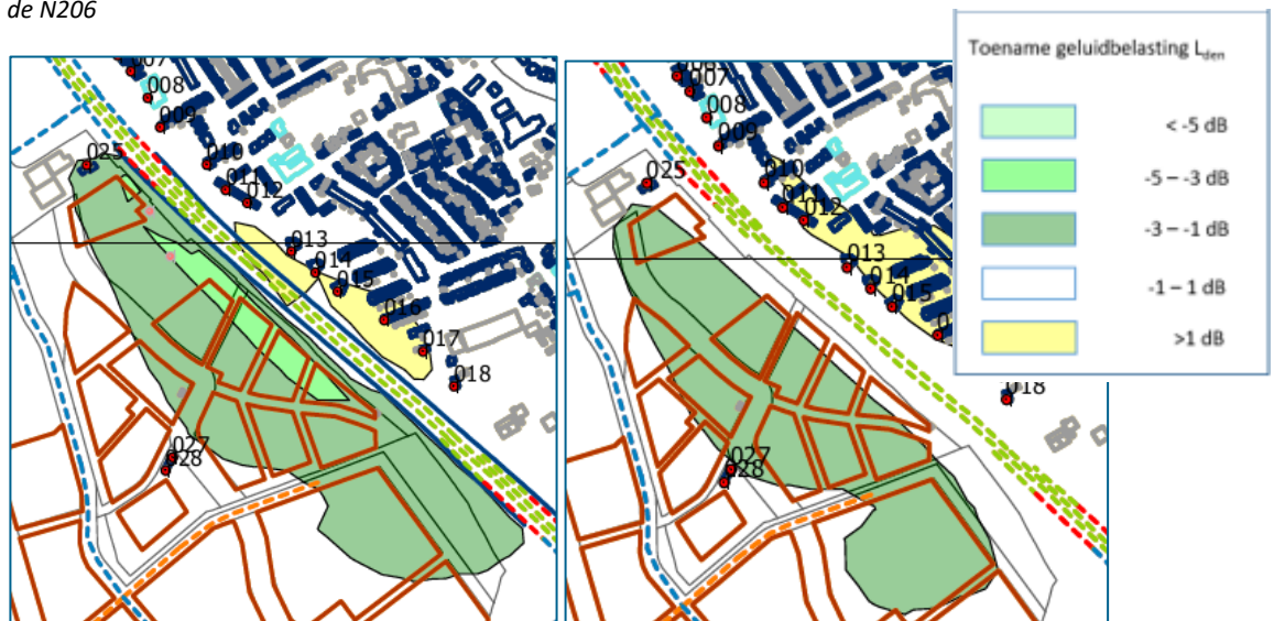
Figuur 8.11 Verschil in geluidbelasting bij toepassing van een 2 m hoog scherm ten opzichte van de plansituatie zonder geluidsscherm op 5 m hoogte (rechts) en 15 m hoogte (links)
