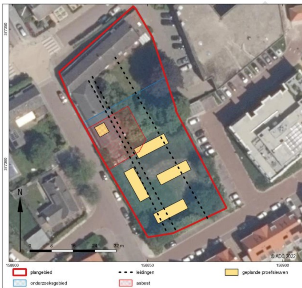
Afb. 6 Vooropgesteld puttenplan met de asbestvervuiling en leidingen
