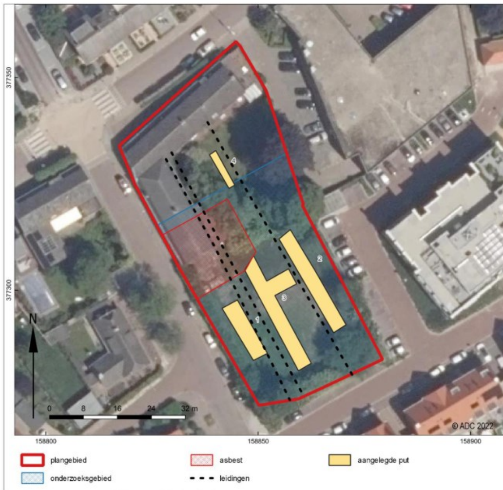
Afb. 7 Aangelegde putten met de asbestvervuiling en leidingen
