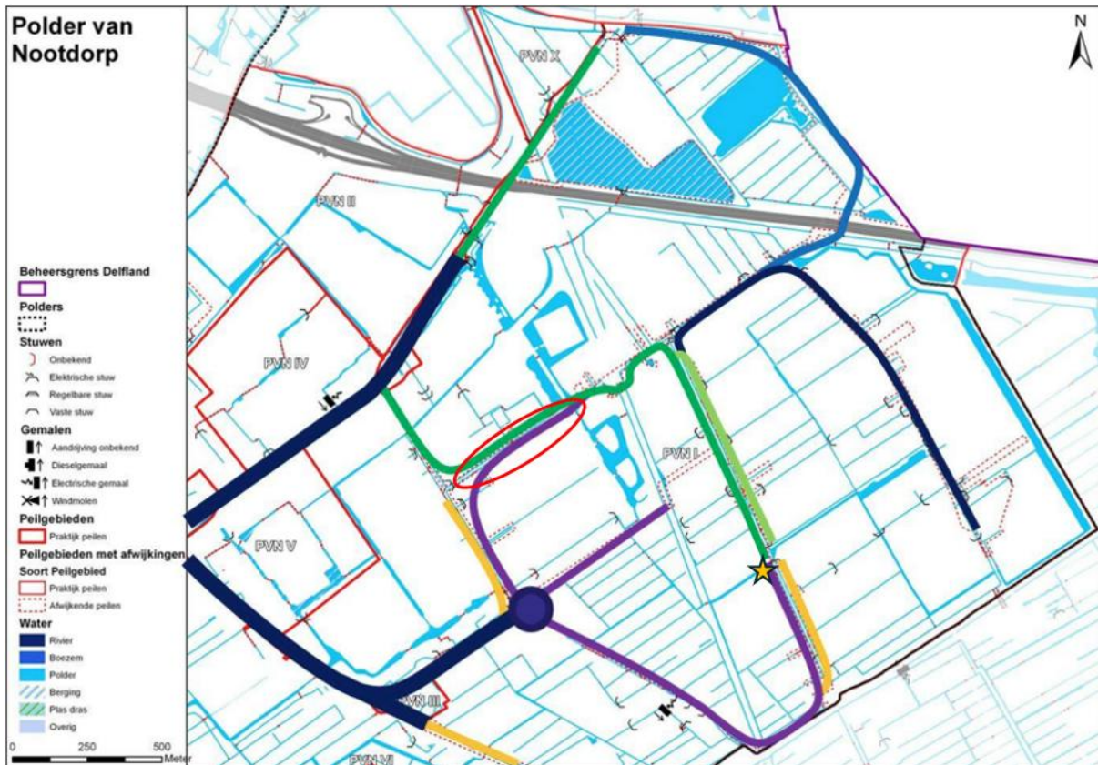
Figuur 4 - Schematische weergave gedeelte binnenboezem en spuisloten. Met rood is de locatie van peilgebied 21 weergegeven. De verschillende kleuren geven de verschillende deelgebieden weer in het spuislotensysteem. Bij de oranje ster is het meetpunt OW215-024.
