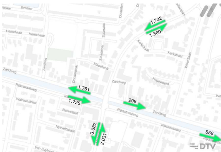
Figuur 2.1 Etmaalintensiteiten van het gemotoriseerde verkeer rondom de Meernbrug (februari 2025)
