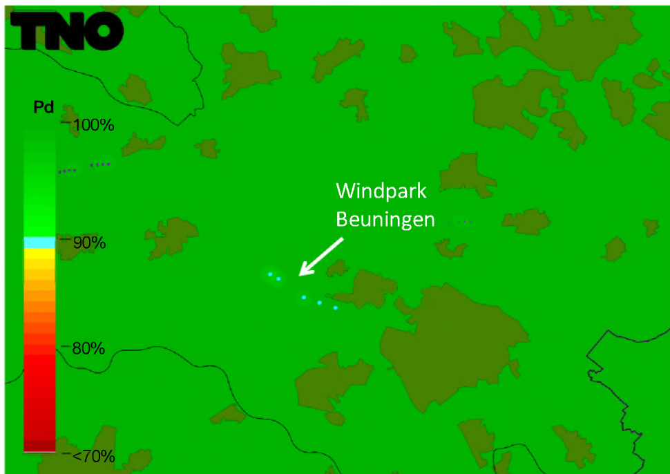
Figuur 11 Detectiekans van het primaire verkeersleidingsradarnetwerk op 1000 voet boven het bouwplan nadat deze is gerealiseerd. De locatie van de nieuwe windturbines is aangegeven met gele stippen.
