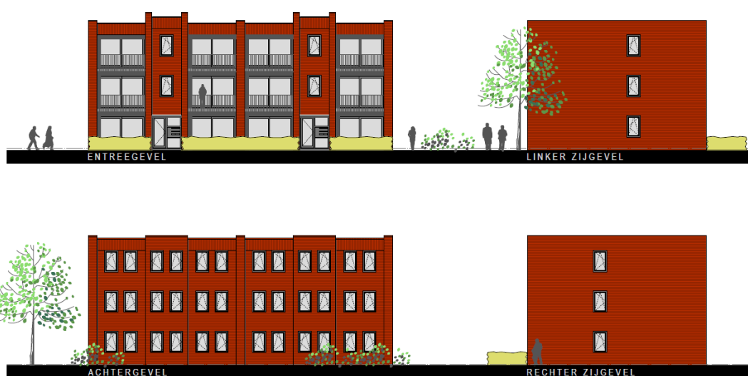
Figuur 2.2 Gevelaanzichten nieuwbouw
