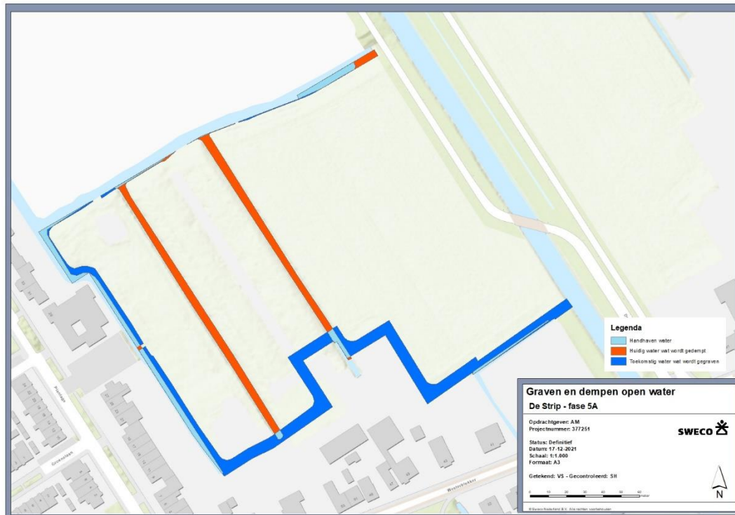
Figuur 3.2: Het graven en dempen van open water in en rondom het plangebied.
