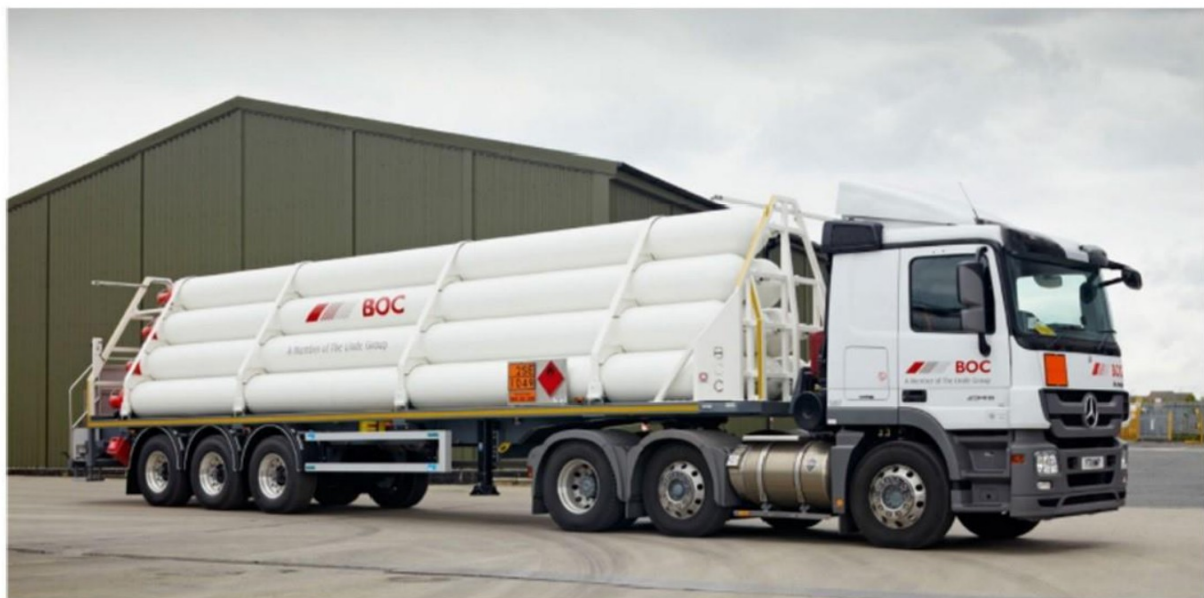
Een tube-trailer met 9 stalen drukcilinders ( 200 bar ) (M-Tech, 2020)
