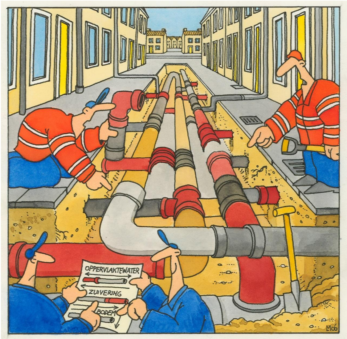
Figuur 7: Met afkoppelen ontstaat het risico van foutieve aansluitingen
