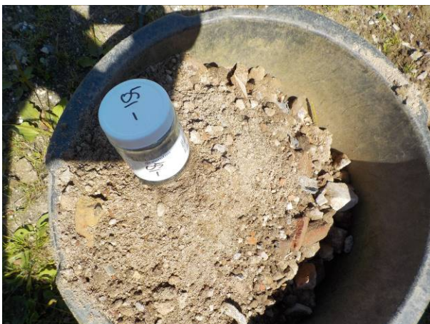
Foto 5: Representatieve foto van puingranulaat als halfverharding op de onderzoekslocatie (boring 5).
