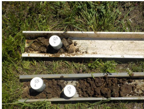
Foto 8: Representatieve foto van leemlaag onder de funderingslaag (#.2) en de daaronderliggende kleilaag (3.3 en 3.4).
