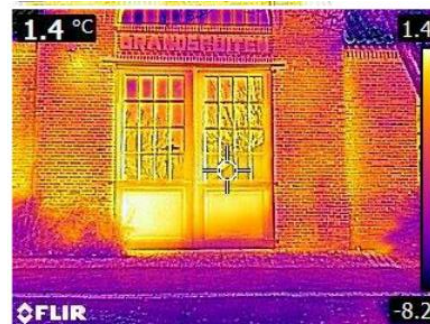
Klokkengieterijpand. Geel /rood geeft warmteverlies aan.
