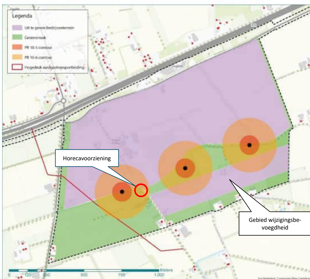
figuur 5.5 Plaatsgebonden risico contouren variant 2a; hogere windturbines
