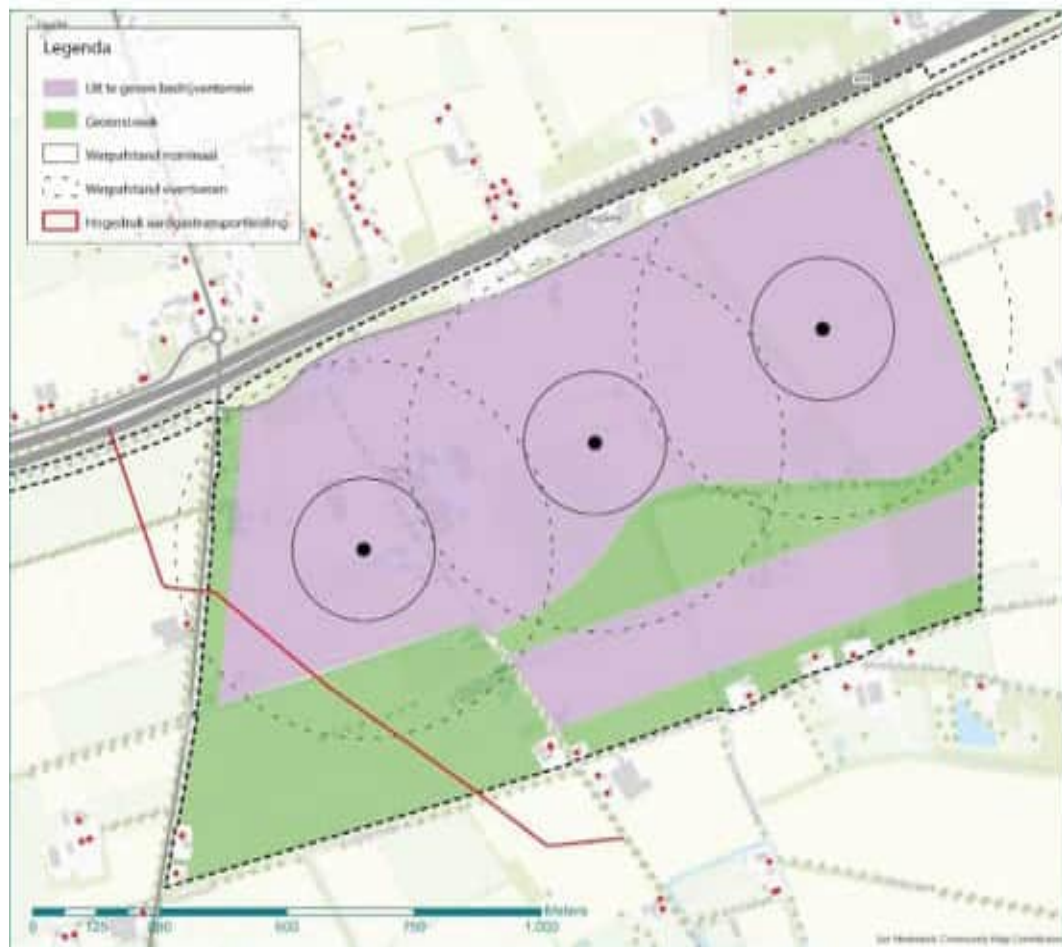
figuur 5.4 Werpafstanden variant 1b (lagere windturbines)
