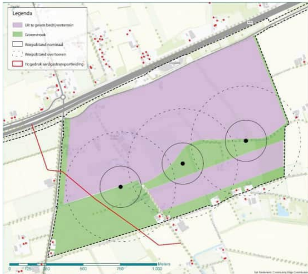
figuur 5.8 Werpfstanden variant EV2b
