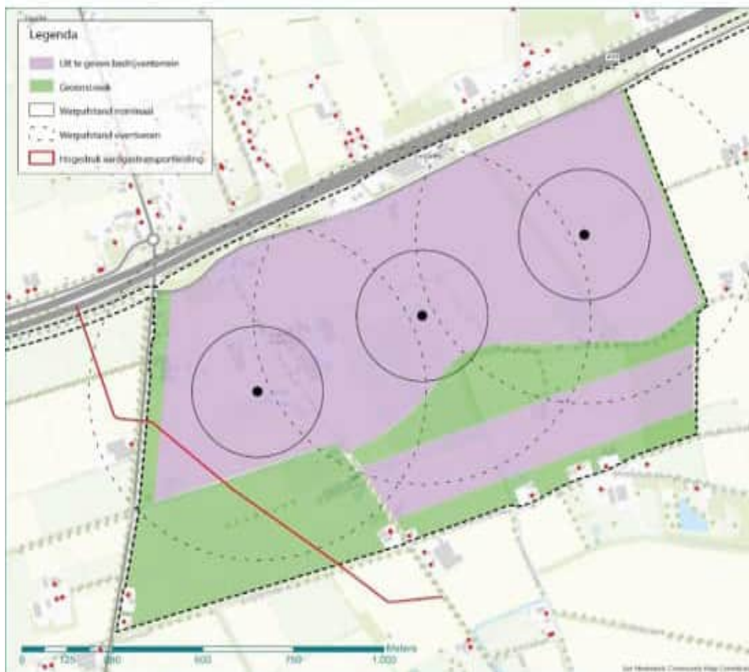
figuur 5.3 Werpfstanden variant 1a (hogere windturbines)
