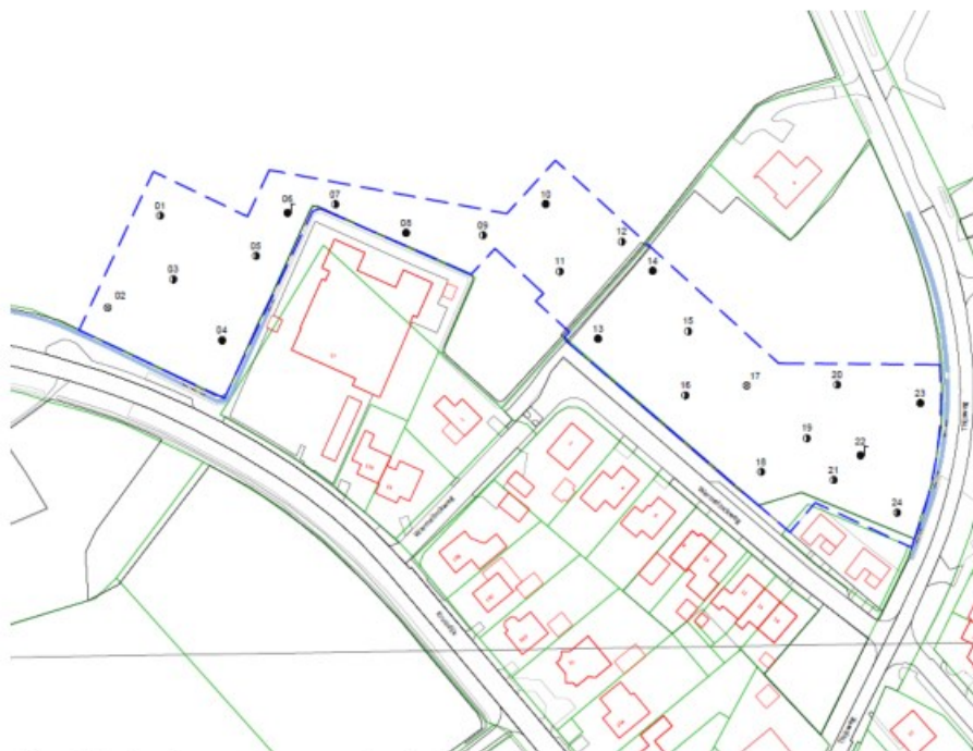
Situatietekening met boorpunten/gaten/sleuven
