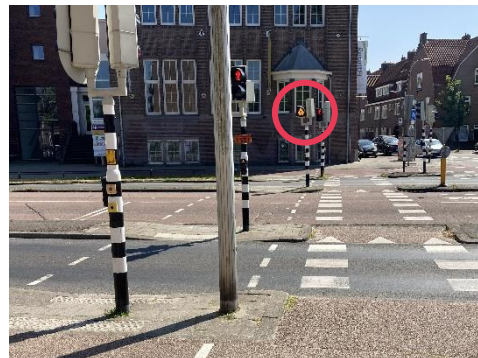
Afbeelding 17: Geel knipperend buswaarschuwingslicht (rood omcirkeld)
