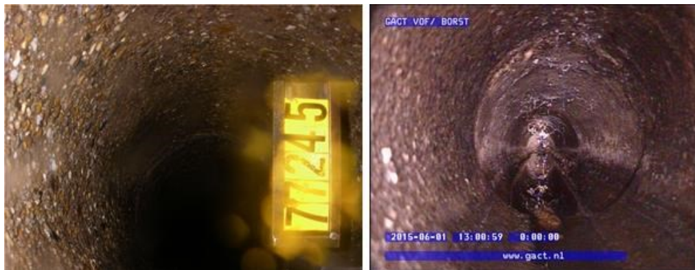
Figuur 25: Links oude cameratechniek en rechts nieuwe cameratechniek
