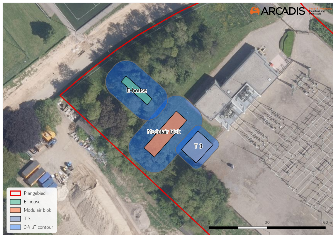
Magneetveldcontour van 0,4 \mu T rondom het voorgenomen E-house, modulair blok en de transformator (T3).
