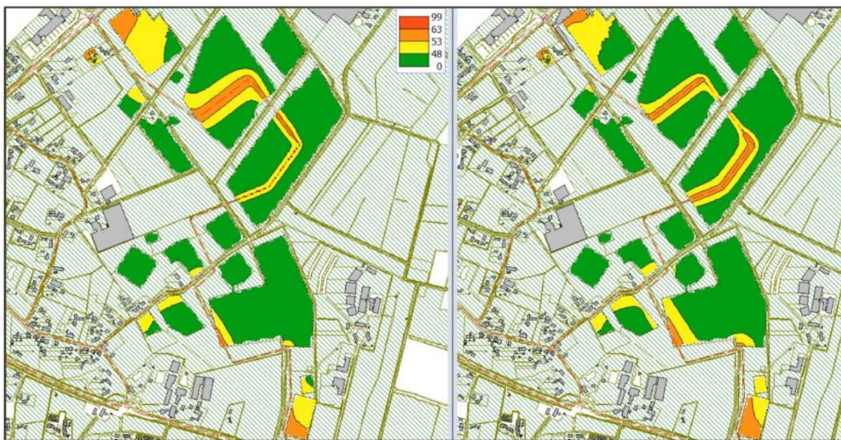
Figuur 4.5 Gecumuleerde geluidbelastingen alle wegen exclusief aftrek artikel 110g Wet geluidhinder [rekenhoogte 5 meter +MV] – variant 1 (links) en 2 (rechts)
