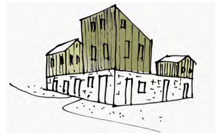
Binnenblok metselwerk plint met houten woningen erboven
