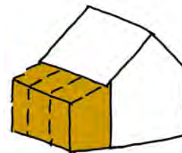
Geluidswering aan de gevel: een serre
