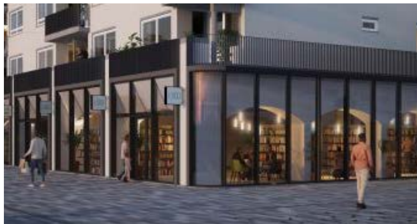
Revitalisering winkelplint: hoge glazen winkelpuien en nieuwe luifels in staal en glas zorgen voor meer zicht op winkels en meer transparantie. Duidelijke scheiding onderbouw (plint) en bovenbouw.
