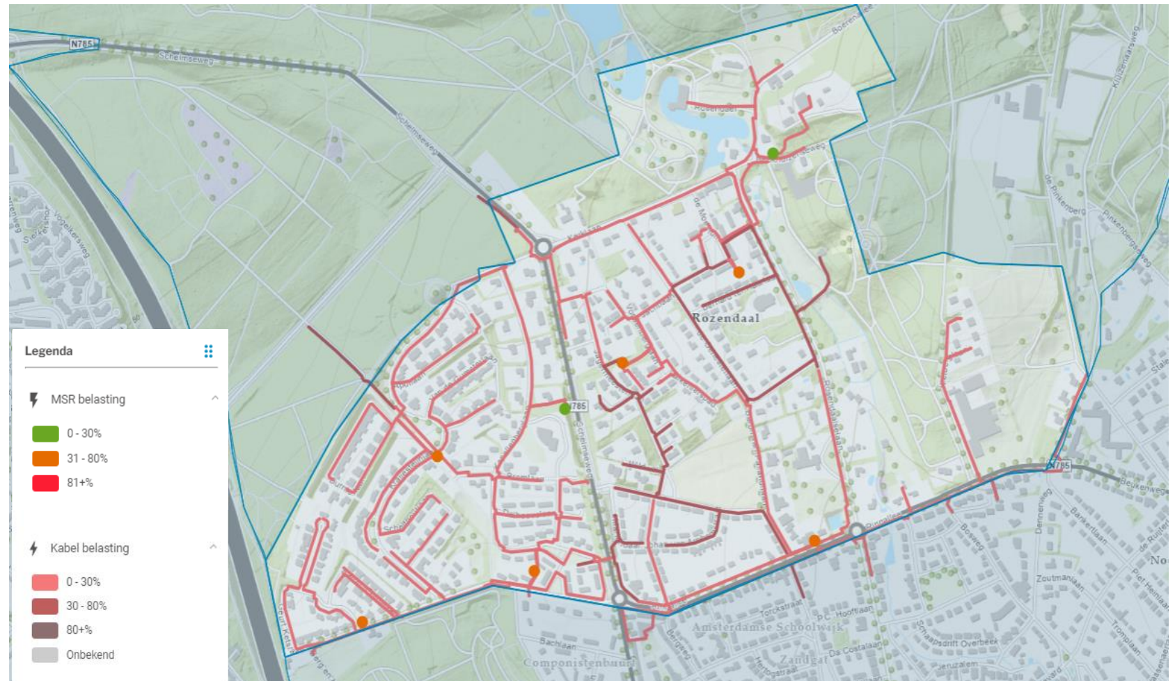
Huidige belasting middenspanningsruimtes (MSR) en laagspanningskabels. (bron: buurtanalyse tool Liander)
