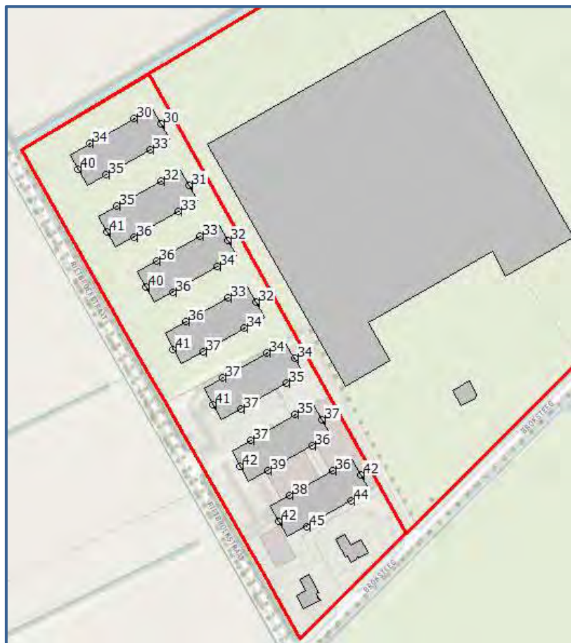
Afbeelding 8. Geluidbelastingen Lden (excl. aftrek art. 110g Wgh) cumulatief Berekende geluidbelastingen op een hoogte van 1,5 meter
