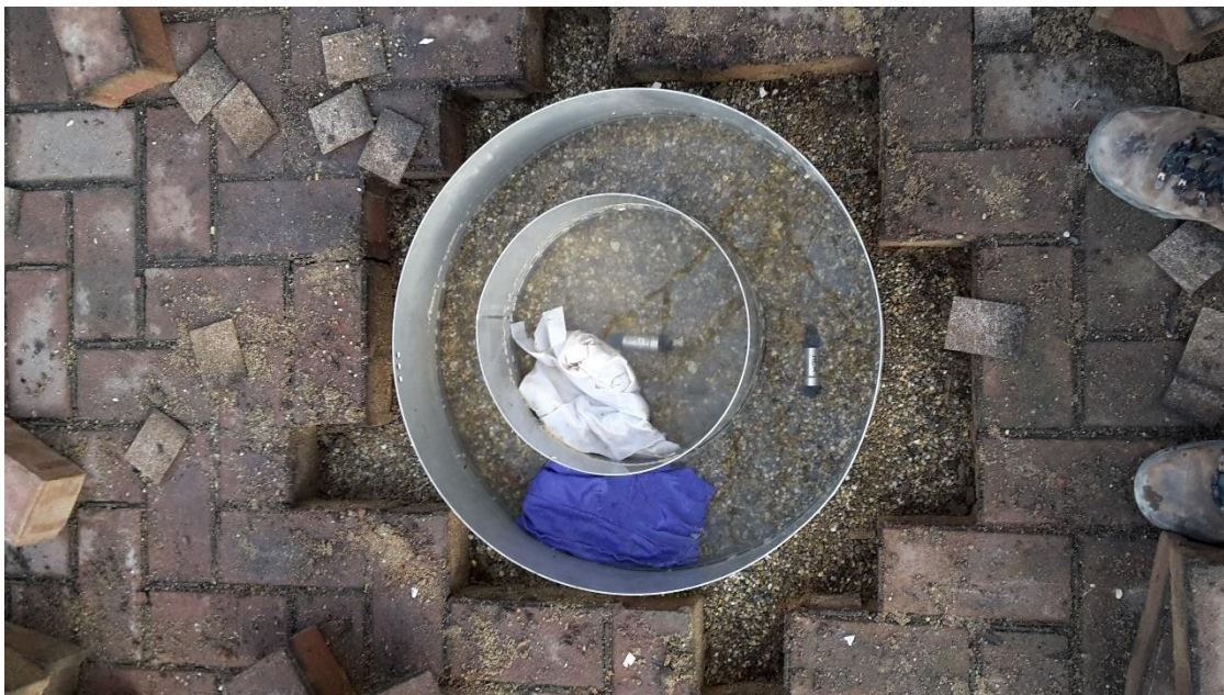
De DRI gevuld met water. In de ringen zijn de doeken en de drukmeters te zien.
