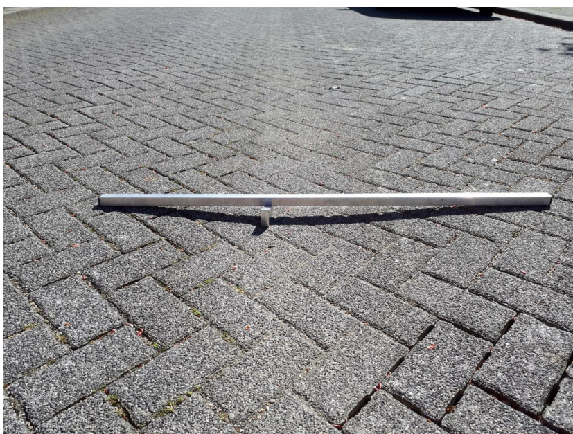
Figuur 22. Spoorvormingsmeting met 1m rei
