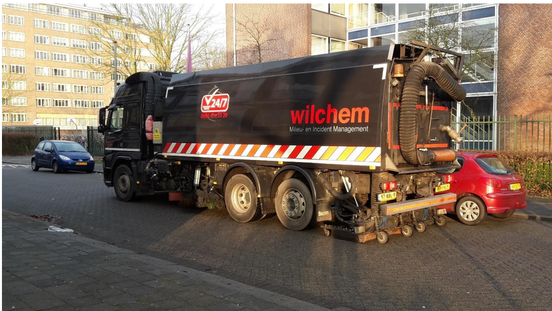
Foto 5: Het reinigen van het wegvak met een Milieu- en Incident reinigingsmachine
