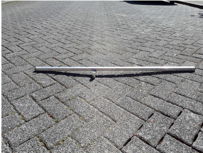
Figuur 3. Spoorvormingsmeting met 1m rei
