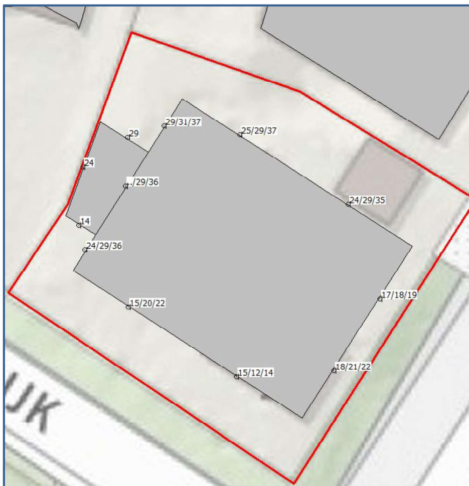
Afbeelding 6. Geluidbelastingen L_{den} (incl. aftrek art. 110g Wgh) Loopkantstraat Berekende geluidbelastingen op een hoogte van 1,5 / 4,5 / 7,5 meter
