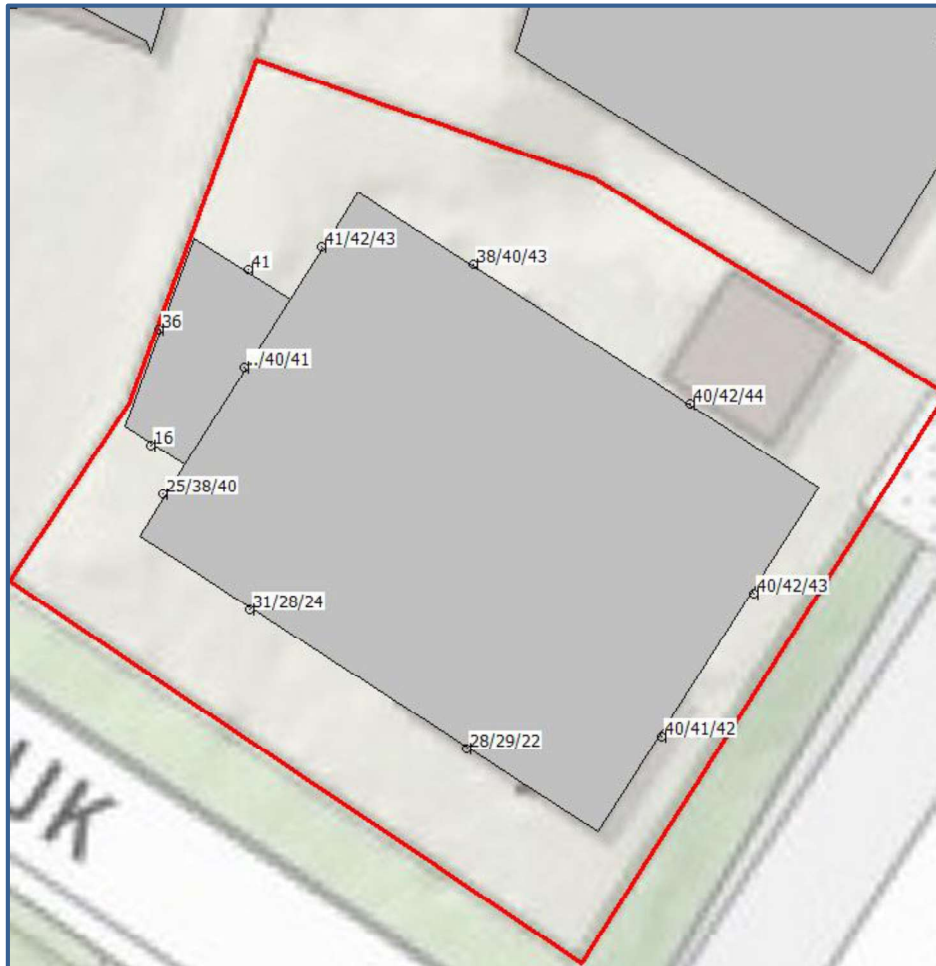
Afbeelding 8. Geluidbelastingen L_{den} (incl. aftrek art. 110g Wgh) Volkelseweg Berekende geluidbelastingen op een hoogte van 1,5 / 4,5 / 7,5 meter
