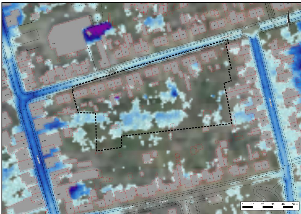
Figuur 4.5 Stressklimaattest, bui 160 mm in 2 uur
