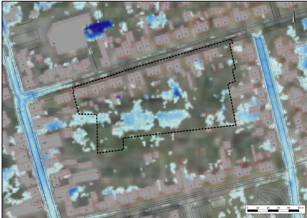
Figuur 4.4 Stressklimaattest, bui 44 mm in 1 uur
